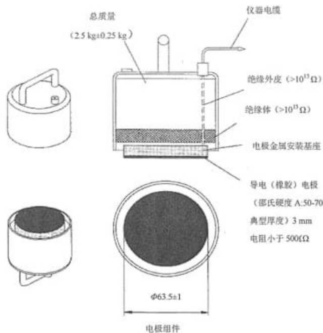
图 A.1 点对点电阻和对地电阻测量的电极组件
